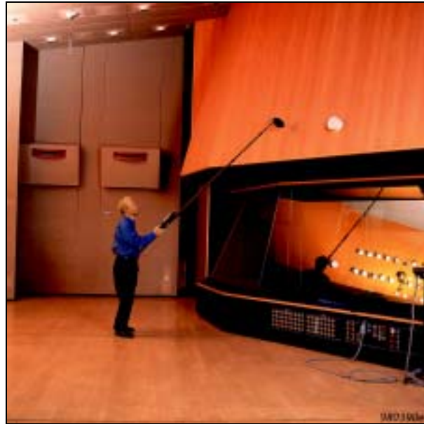
Fig. 16 Mappatura della riduzione acustica per rilevare le perdite sonore tra lo studio di registrazione e la cabina di controllo
